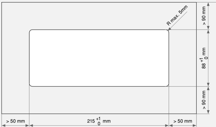
Fräsmaß Flächenbündig | Milling dimension: Flush Mounting | Dimension de fraisage Montage Affleurant
