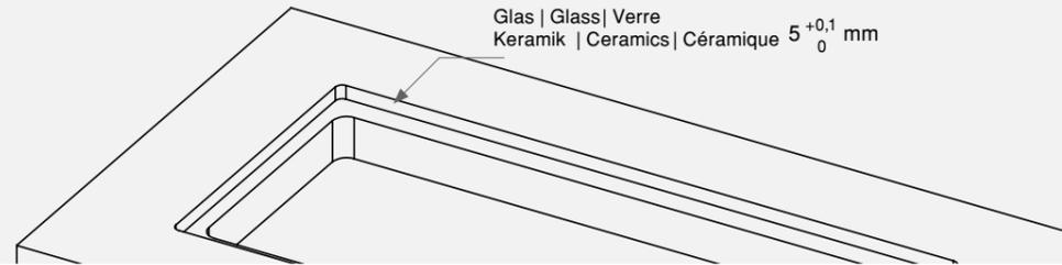
Einbauanleitung | Installation Instructions | Guide d'installation
